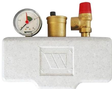
Группа безопасности котла предназначена для защиты закрытых систем отопления от избыточного давления и завоздушивания. Включает в себя предохранительный клапан, автоматический воздухоотводчик (с запорным клапаном) и манометр, смонтированные на стальной консоли.
