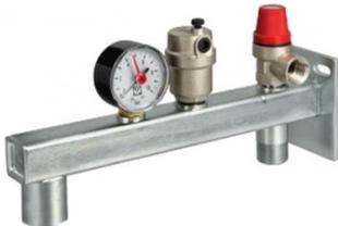
Группа безопасности котла предназначена для защиты закрытых систем отопления от избыточного давления и завоздушивания. Включает в себя предохранительный клапан, автоматический воздухоотводчик (с запорным клапаном) и манометр, смонтированные на стальной консоли.
